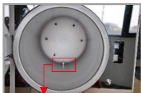
1. Filtro de agua de la cámara
